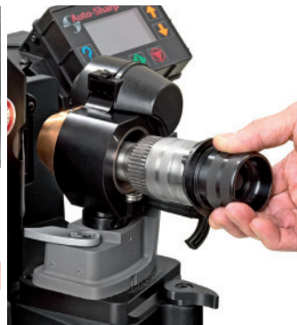
2. Das Spannfutter gemäß Markierung in die Führungshülse einführen und Arretierhebel umlegen.
