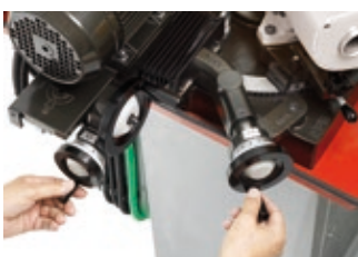
Abtragseinstellung der Werkzeuge per Fein- oder Eilzustellung.
