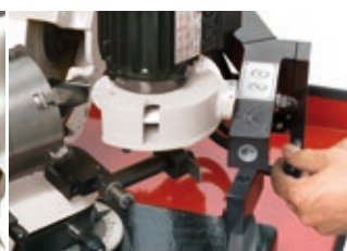
Definiertes und variables Ausspitzen in einer Aufspannung mit integrierter Ausspitzeinrichtung.
