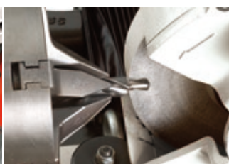
Stufenbohrer: Rundschleifen der Bohrstufe
