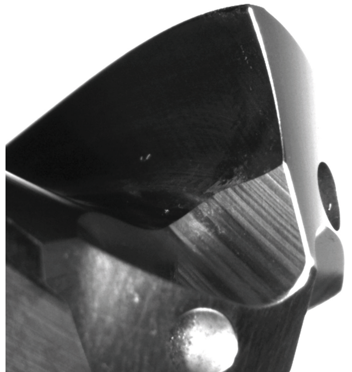
Detailansicht: Rückenkante nach dem Bürstvorgang
