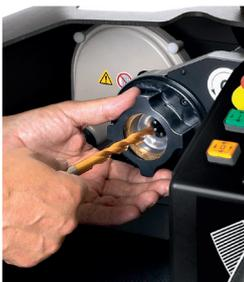
Einführen des Bohrers in das Präzisionsspannfutter Spannereich 3,0 – 16,0 mm
